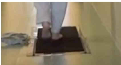
図8 マット型接触荷重分布センサ
