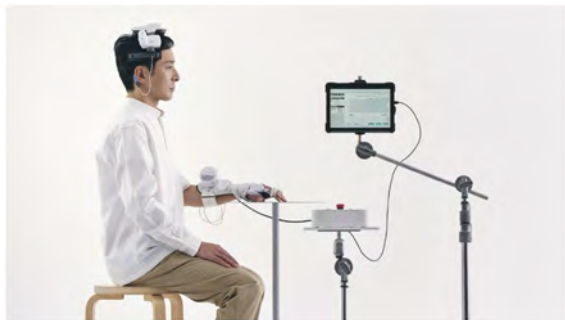
図2 脳波計測システムと上肢麻痺介入装置を組み合わせたBCI機器
